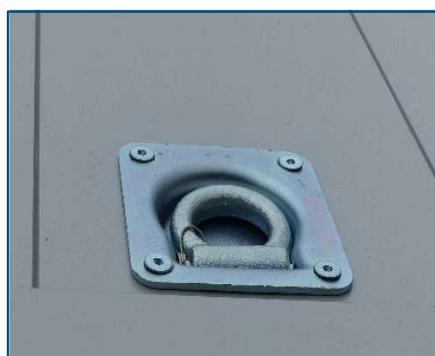
Bussole di ancoraggio certificate Secondo la norma DIN EN 12640.
