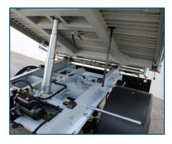
Benne basculante et faux-châssis entièrement en alliage structurel d'aluminium.
